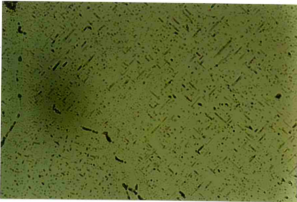
Figura 11: Micrografia de tarugo da liga 6061 homogeneizado a 570°C durante 2 horas.
